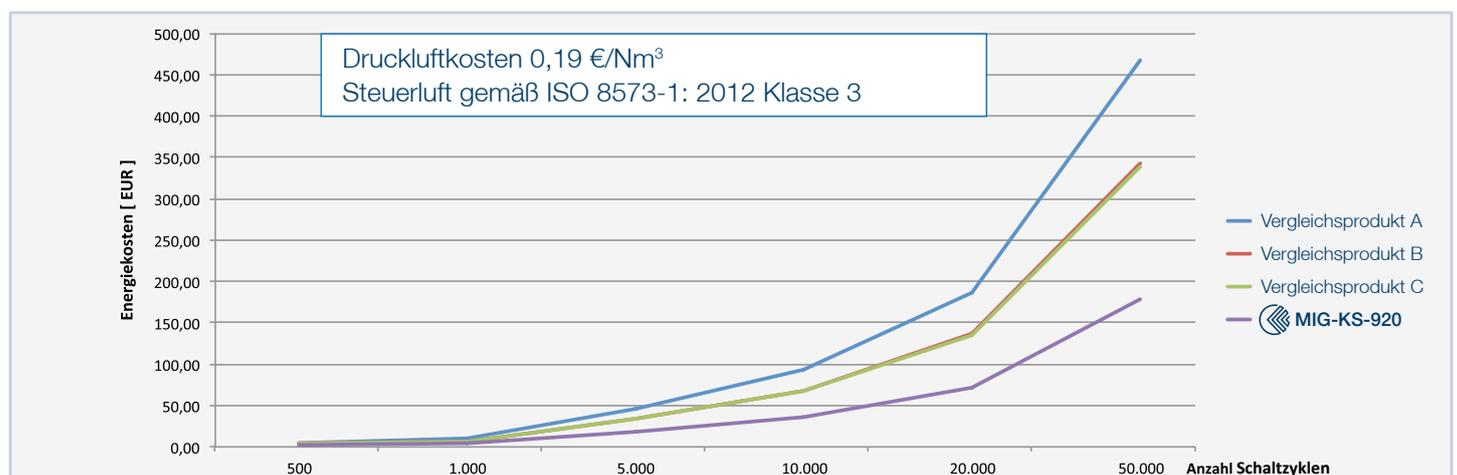
Der Vergleich der Herstellerangaben zu dem durchschnittlichen Luftverbrauch zeigt bereits beim einfachwirkenden Antrieb und in zunehmendem Maße beim doppeltwirkenden Antrieb sehr deutlich, dass bereits nach 1.000 Schaltspielen die Lebenszykluskosten des Antriebs MIG-KS signifikant niedriger sind.
